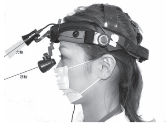
(図.3) ルーペは視軸と光軸が平行でなく角度を持つ
