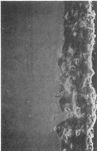
図3 A HA焼結コーティングの状態 厚みは均一で表面平滑
