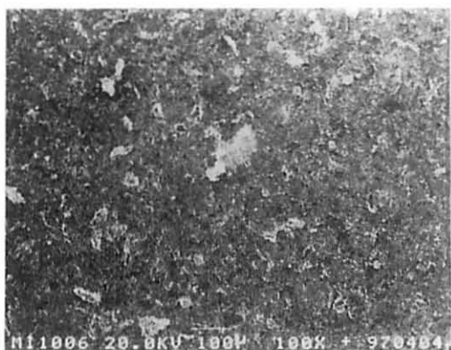
図6 A HA Blast ×100 HAブラストによってチタン表面に陥入したHAのTCP
