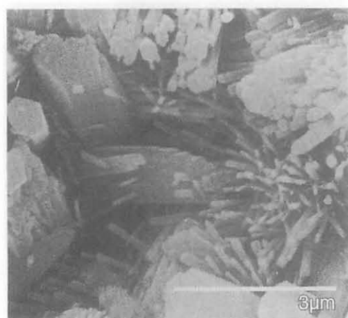
図4 B HA再結晶化コーティング ×1000 TiO 2 層上に析出したHAの結晶がみられる
