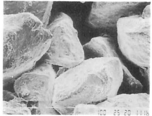
図8 粗粒アパタイト・ブロックの粒子形態と多孔構造
