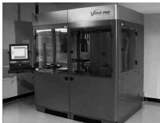
図2 積層光造形法のための造形機 (Stereolithography Apparatus, SLA)
